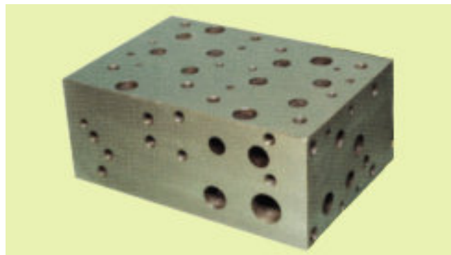
Fig. 23 : La structure fine et compacte de la pièce coulée en continu convient idéalement à la fabrication des pièces hydrauliques étanches à la pression et aux gaz (source : Contifonte, Kuhn / Saverne (F)).
