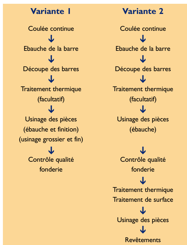
Fig. 4 : Les différentes étapes de fabrication des pièces en fonte coulées en continu.
