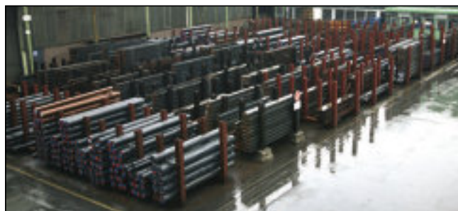
Fig. 3 : Stock de jets coulés en continu, de formes, de tailles et de longueurs variées (source : K. Vollrath, Rees).
