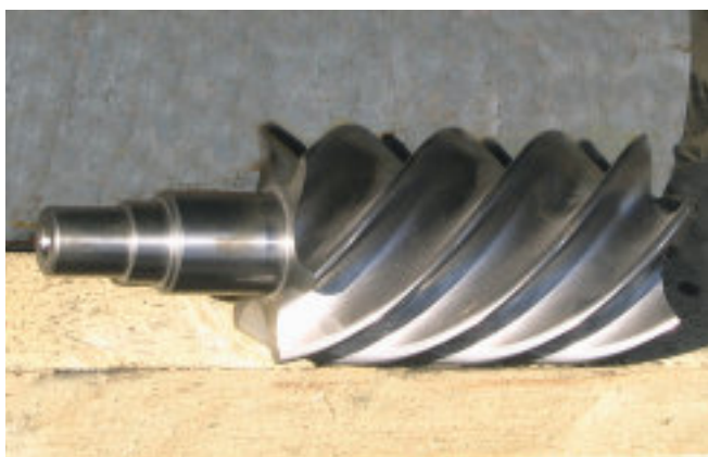
Fig. 12 : À partir de jets préusinés dans la fonderie, conformément aux désirs du client, les produits finaux peuvent être rapidement fabriqués et à un coût intéressant pour lui (source : K. Vollrath, Rees).
