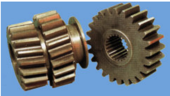
Fig. 22 : Roues dentées et couronnes dentées en fonte : produits finaux en coulée continue typiques, qui se caractérisent par une dureté élevée et uniforme et une bonne usinabilité (source : Contifonte, Kuhn / Saverne (F)).
